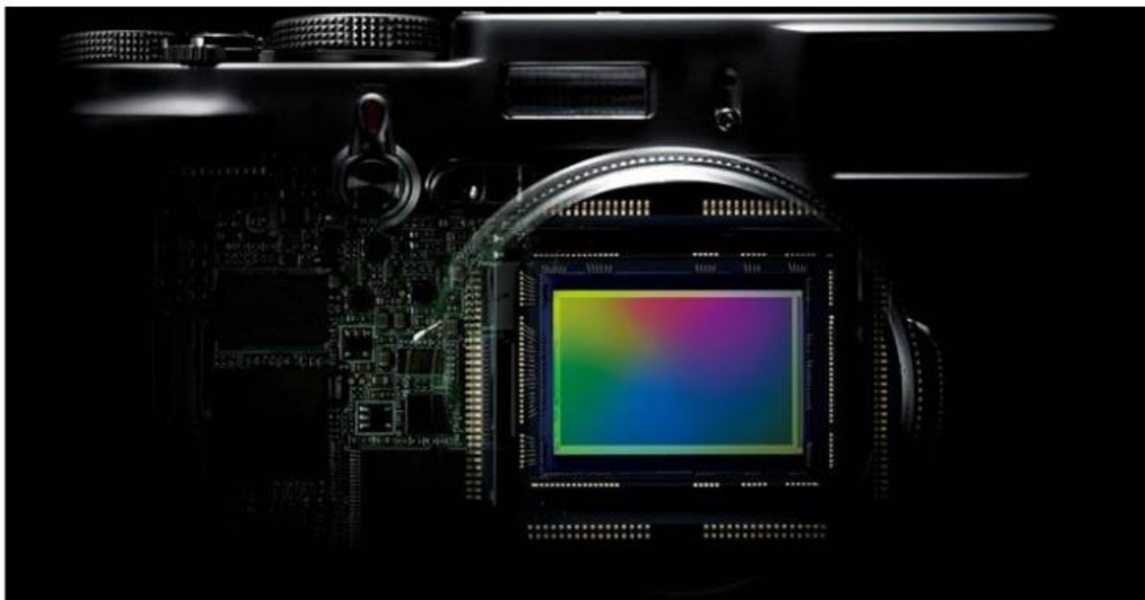
Ο αισθητήρας στο εσωτερικό μιας φωτογραφικής μηχανής. Μια πλήρης εφαρμογή του φωτοηλεκτρικού φαινομένου.
